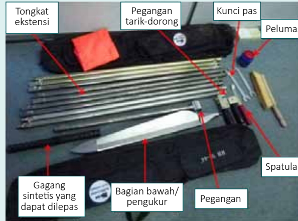
Gambar 1.2: Alat bor gambut dan metode penggunaan. (Sumber gambar: Global Environment Centre, GEC)
