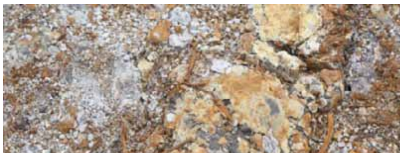
Gambar 2.7: Tanah sulfat masam yang menguning akibat oksidasi belerang.
